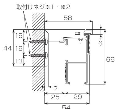
※1 取付けネジは下地位置の状況に応じて図のどちらかの位置に取付けてください。
